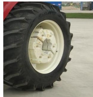
**⚠ 注意：**将带后配重后轮从拖拉机上拆下之前，应首先从轮胎上拆去后配重，以免发生失稳的危险。
