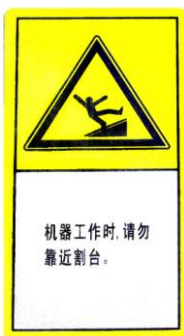
3.安全警告标志 割台两侧壁
