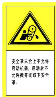
4.安全警告标志 各防护罩外侧
