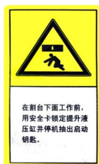
5.安全警告标志 过桥两侧壁前部
