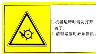
9.安全警告标志 脱粒机两侧检查盖处
