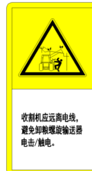
10.安全警告标志 卸粮筒
